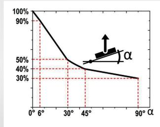
**Max. Gewicht der Last bei 3:1 Sicherheitsfaktor =  $90\text{ kg} \times 100\% \times 30\% = 27\text{ kg}$**
