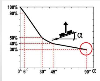
**Poids max. de la charge avec coefficient de sécurité de 3:1 = 90 kg x 100 % x 30 % = 27 kg**
