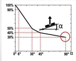
**Peso máx. de la carga con factor de seguridad 3:1 =  $90 \text{ kg} \times 100 \% \times 30 \% = 27 \text{ kg}$**
